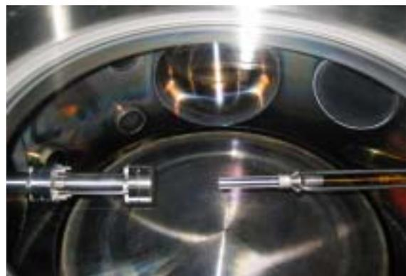
写真1 径9mm のH,N,Oラジカルモニタリングセンサー
