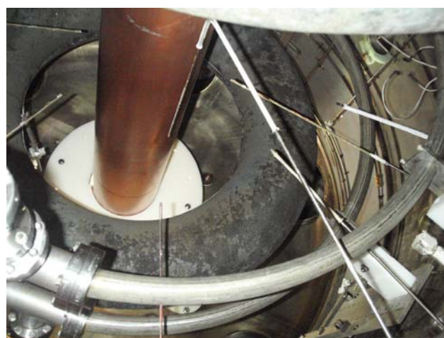
写真3：実験装置の内部。多数見える細い管が滞在中に製作した磁場計測用のプローブ。
