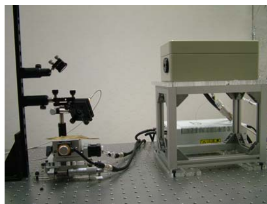
図 5 レーザ誘起ブレイクダウン分光システムの外観
