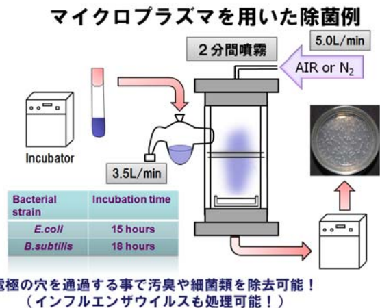
図5 マイクロプラズマによる除菌実験例
