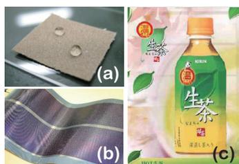
図 3. プラズマ CVD の持つ「低温」の効用例。(a) 紙の上の超はっ水膜(名古屋大学 井研究室), (b) 高分子基板上へのフレキシブル太陽電池(AIST), (c) PET ボトルへのガスバリアコーティング(キリン/三菱重工/SAMCO)。
