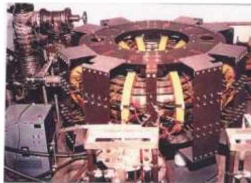
図1. 国内初とされる産総研におけるトーラス型プラズマ放電実験装置[1]。
