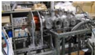
図 3 開発した高密度ヘリコンプラズマ装置例：上から大きいサイズ順に LHPD (Large Helicon Plasma Device：宇宙科学研究所で開発した世界最大の装置、直径 74 cm、長さ 486 cm)、LMD (Large Mirror Device：種々の基礎から応用までの研究に寄与)、HFD (High Field Device：完成当時世界最強磁場 1 T で、 10^{13} \text{ cm}^{-3} の電子密度を十分超える)、SHD (Small Helicon Device：世界最小口径の 0.5 cm まで達成し更に開発中)
