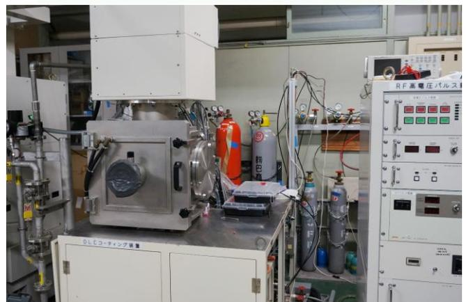
図 1 RF-HV 重畳型プラズマイオン注入成膜装置の基本構成[3]
