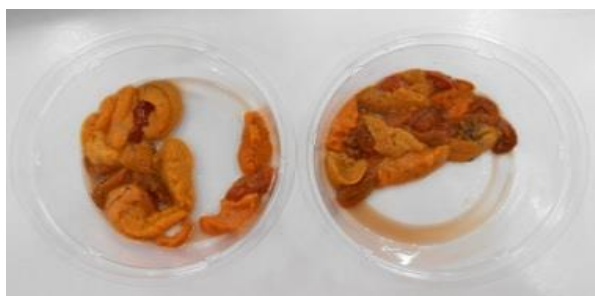
図 11 電場の有無によるウニの保存状態の差異（保存期間：7日間，左：電場あり，右：なし）
