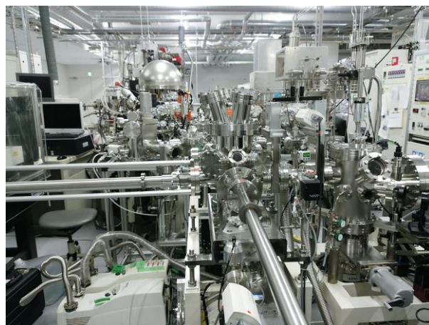
図 2 最先端プラズマエッチング装置およびラジカル制御プラズマビーム装置と気相および多様な表界面計測装置が真空中で連結したプラズマプラネタリーシステム。
