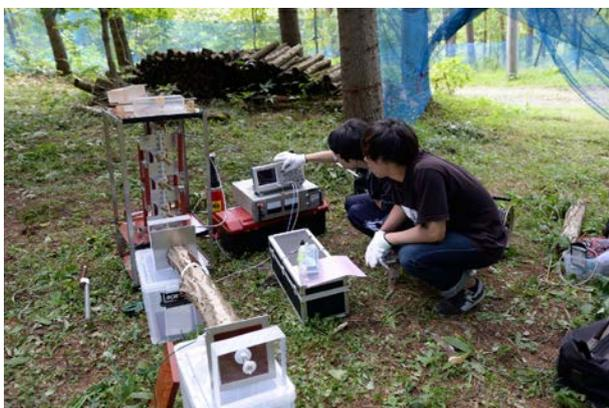
図3 キノコホダ木へのパルス印加実験の様子
