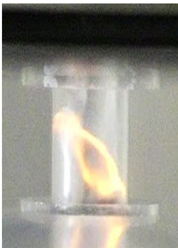
図6 電極から離れた位置での水中プラズマ。 気泡が膨らんだ部分で電場が強くなり、 プラズマが円環状に維持されている。
