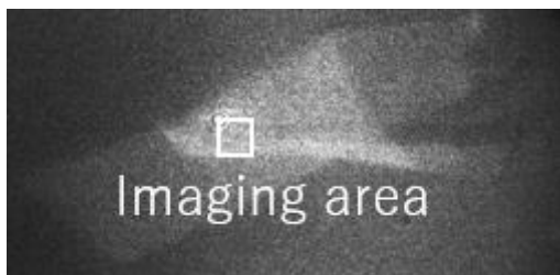
図2 (a)単層 WSe 2 の反射顕微画像 (b)単層 WSe 2 の PL 強度分布
