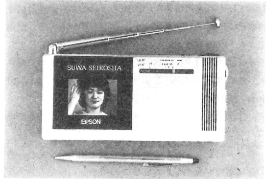
図9 TFT アクティブマトリックス方式によるフルカラー液晶ポケットテレビ
