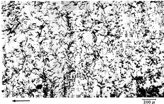
図8 アルミナ単結晶内の転位像 転位線 // a 軸, 矢印は光の入射方向を示す。 入射波の電界方向は紙面に平行。
