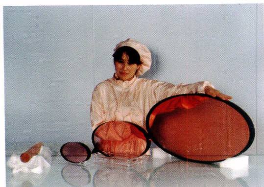
図 6 リン酸塩レーザーガラス 左より R 50, D 100, D 200, D 350 用
