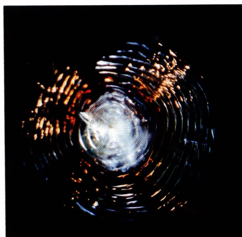
図 7 白金混入レーザーガラスの内部損傷 最外円の直径は約 3mm
