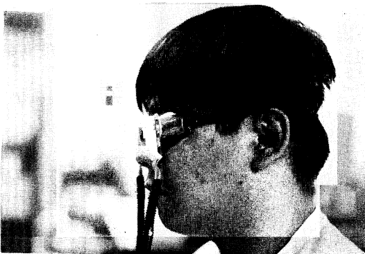
図 14 超軽量の HMD (EPSON 0.7 インチ液晶パネル使用)
