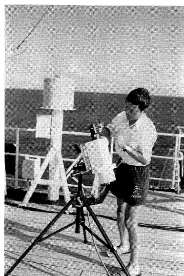
図8 白鳳丸による大気エアロゾルの偏光観測 西太平洋域のエアロゾルの放射特性を把握して、衛星データ解析に役立っている。
