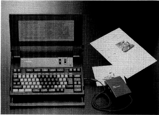
図10 モノクロ STN 型を用いた初期の液晶ワープロ (NEC)
