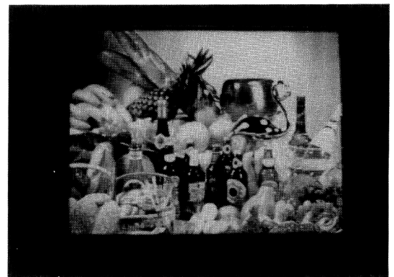
図13 反強誘電性液晶を用いた6インチフルカラーLCD試作品 (日本電装提供)
