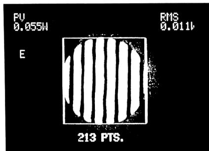
図3 無電解ニッケル凹面切削加工結果 ( $\phi 30\text{ mm}$ ,  $R 30\text{ mm}$ )。
