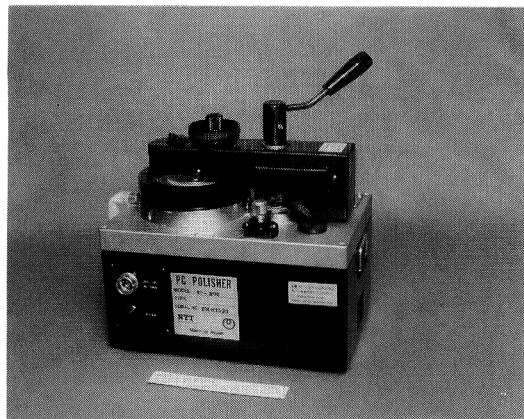
図7 1工程高速研磨装置。
