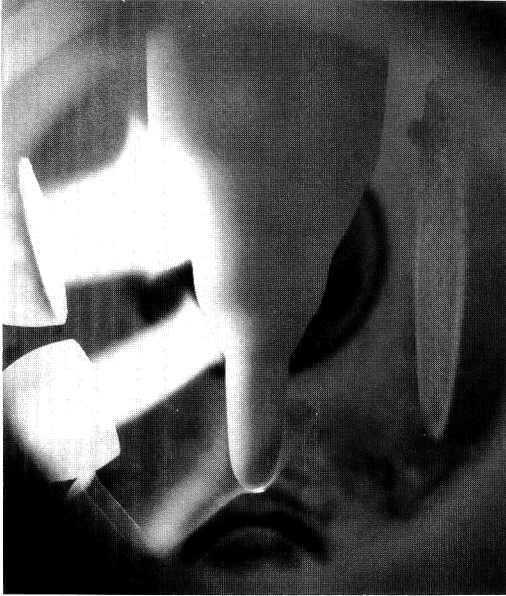
図8 VAD法による単一モードファイバー用多孔質母材の作製状況。
