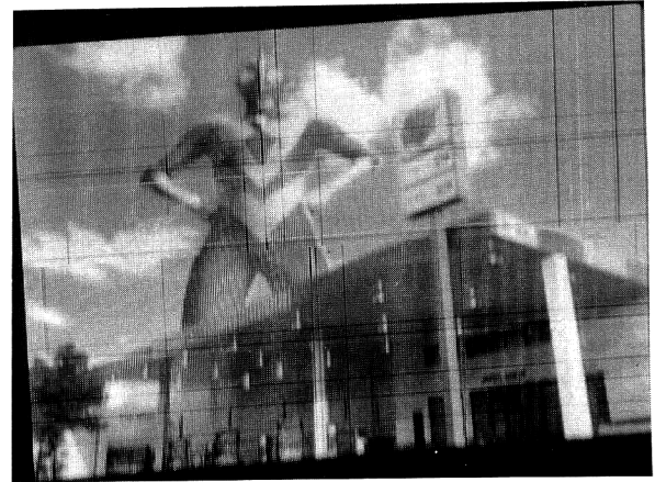
図4 5インチ QVGA フルカラー有機 EL ディスプレイの写真.
