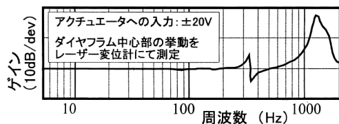
図4 可変焦点レンズの周波数特性.
