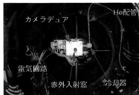
図 5 天文観測用赤外カメラがセットされた東京大学木曾観測所 105 cm シュミット望遠鏡内部。使用されているのは 1,040×1,040 画素 PtSi ショットキーバリアー FPA (東北大学市川隆氏写真提供)。
