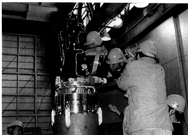
図5 打ち上げ直前のチェック中のX線ドップラー望遠鏡。1997年1月31日に宇宙科学所の発射場から打ち上げられ、高度200 km以上で5分間太陽コロナの観測に成功した 15,17) 。
