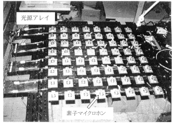
図10 64素子光ファイバーマイクロホンアレイの外観.
