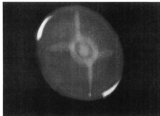
図2 中間赤外線観測装置COMICSの瞳像。波長11.6 \mu\text{m} で取得された瞳像を疑似カラーで表示したもの。黒-青-赤-黄-白の順に放射が強くなる。瞳や副鏡が丸くないのはCOMICSの瞳光学系の収差である。瞳は4枚の非球面反射鏡で構成された軸外しの光学系の対称位置にある。星像の収差を最小にするために瞳像の収差は大きくなっている。COMICSでは、この瞳像をモニターしながら装置と望遠鏡の光軸合わせを行う(国立天文台・COMICSチーム提供)。
