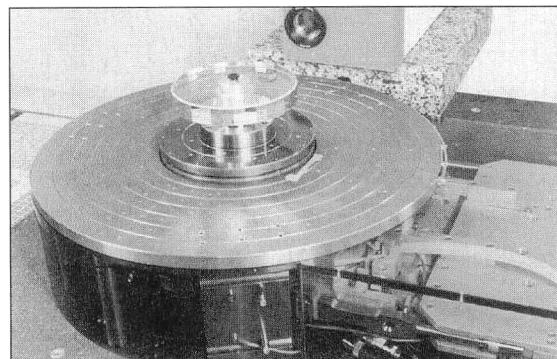
図9 ドイツロータリーエンコーダー校正装置(国家標準:PTB開発)。
