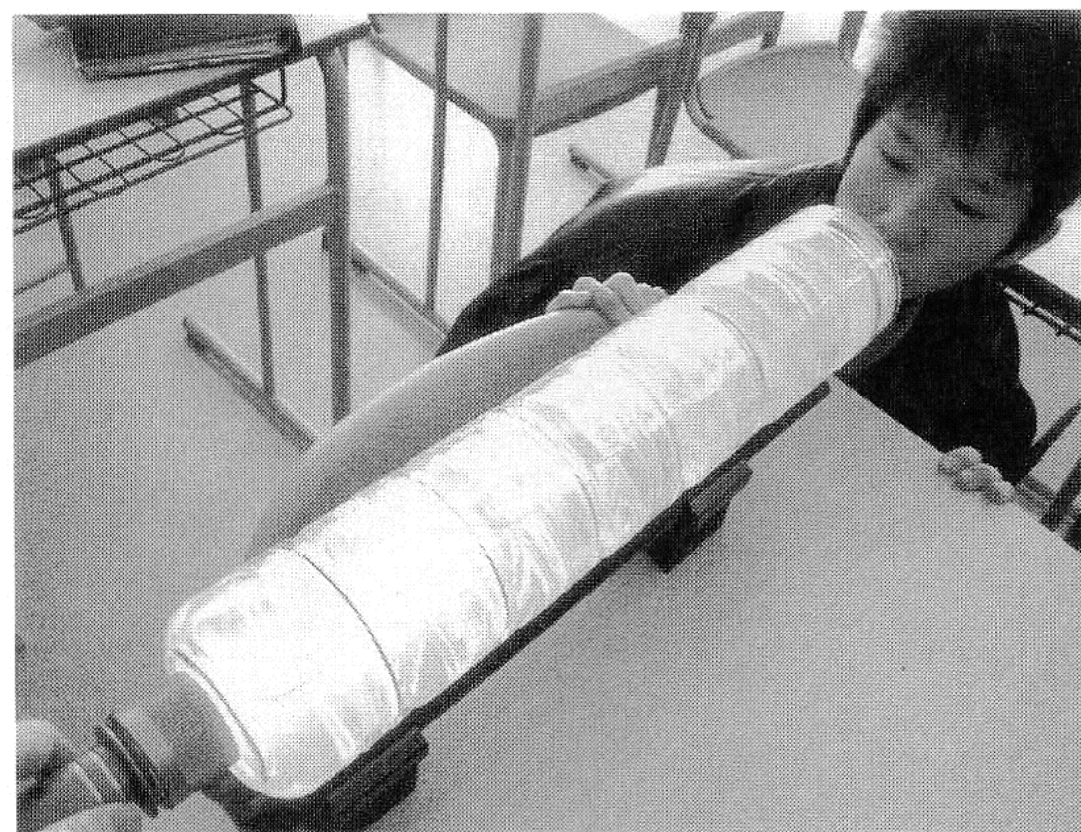
図1 レイリー散乱の観測実験。側方からの散乱光は空の色を再現し、透過光は太陽の色を再現している。白色LEDを使うことで青空の色がはっきりと確認できる。
