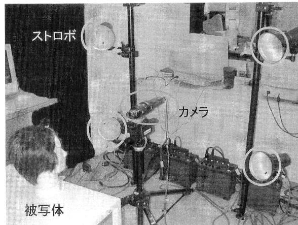
図2 実験で用いた時空間照明変調法による肌色のモニタリングシステム。
