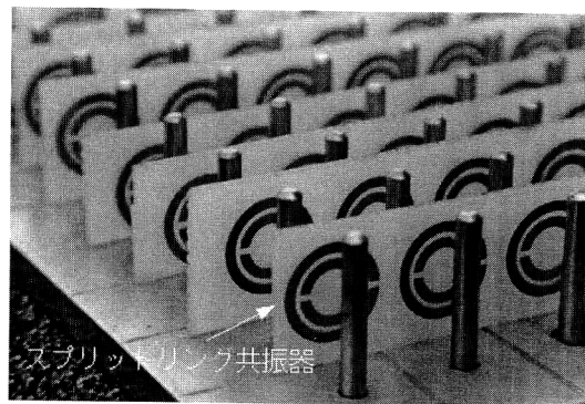
図3 SRRで構成されたメタマテリアル。
