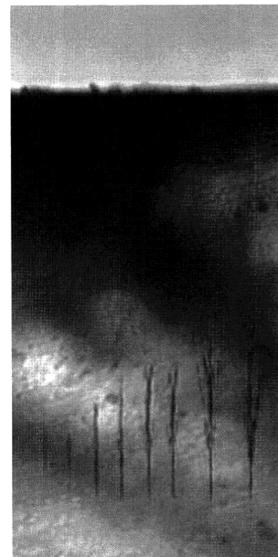
図2 爪に記録されたビットの横からの顕微鏡像。写真の縦と横の長さは、 200\ \mu\text{m} と 100\ \mu\text{m} である。
