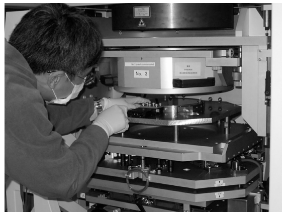
図4 装置本体にシリコンウェハーを固定.
