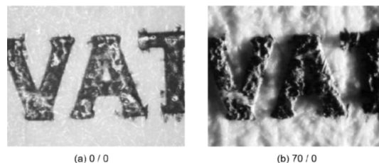
図2 測定ジオメトリーによる見え方の変化 (米国100ドル紙幣, 凹版印刷部)。(a) ジオメトリー 0/0, (b) ジオメトリー 70/0。
