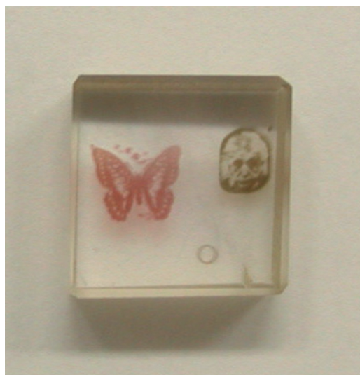
図2 Au ドープガラス。イメージ：フェムト秒レーザー照射前，蝶：フェムト秒レーザー照射後，さらに 550^{\circ}C で熱処理。
