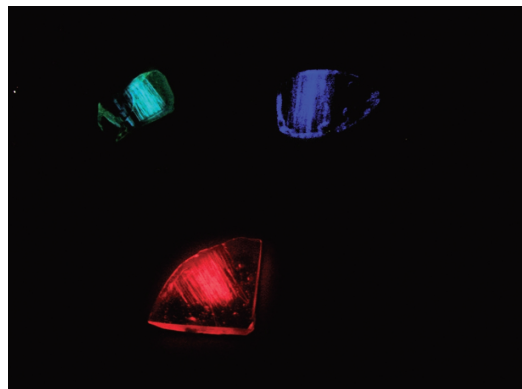
図6 フェムト秒レーザー照射後ガラスが長残光を発している写真。青、緑、赤色に発光しているのは Eu^{2+} , Tb^{3+} , Pr^{3+} ドープのガラスである。
