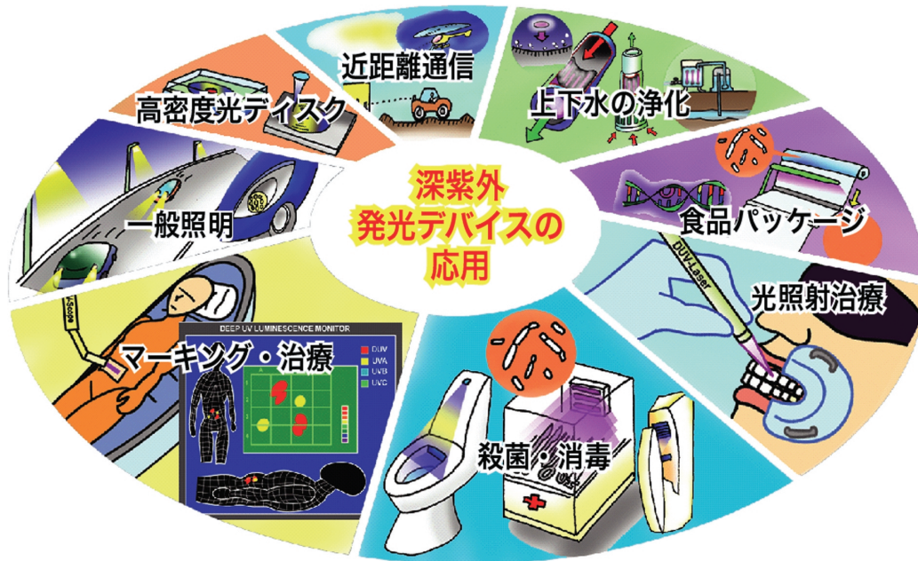
図1 深紫外発光デバイスの応用例。波長 200～350 nm の深紫外光には白色光源をはじめ，殺菌や公害物質の分解，医療，通信など幅広い応用分野がある。
