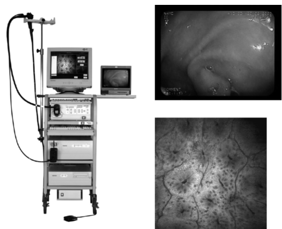
図6 共焦点内視鏡観察システム。(左) システム外観、(右上) 内視鏡通常観察画像、(右下) 共焦点観察画像。
