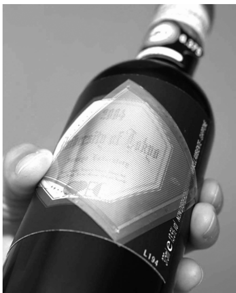
図1 製造されたシート型スキャナーのイメージ写真。ワインボトルのラベルもそのままスキャンできるなど、ユニークな利用方法が期待できる。
