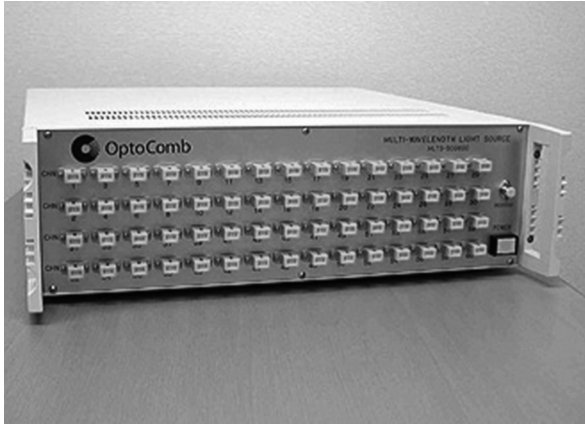
図3 導波路型光周波数コム発生器を用いた多波長光源。
