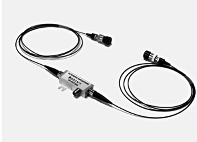
図1 導波路型光周波数コム発生器。
