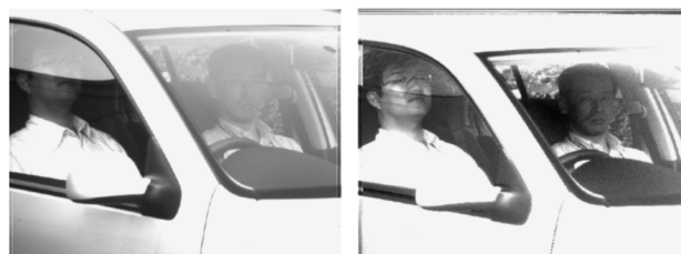
図4 偏光イメージングカメラで撮影した写真(処理前(左)と処理後(右))。リアルタイムで任意の方向のガラス面の反射を除去することができる。
