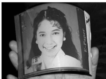
図1 光書き込み型電子ペーパー（モノクロタイプ試作品）。
