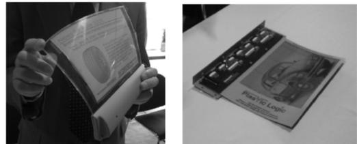
図4 フレキシブル電子ペーパーの試作サンプル。左：ブリヂストン製、右：Plastic Logic 社製。
