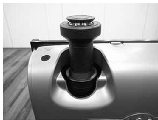
図6 試作された全方位プロジェクター。
