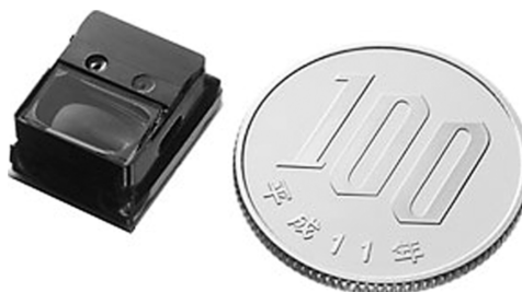
図10 試作された撮像モジュールの概観。
