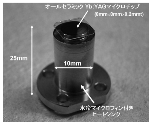
図3 ヒートシンク接合された Yb:YAG マイクロチップの外観。
