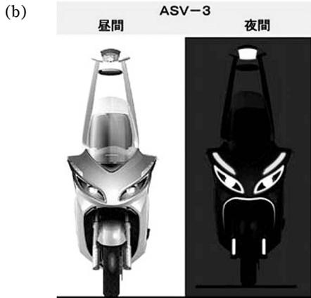
図4 先進安全自動車の開発例. Honda ASV-3のFACEデザインとLONGデザイン. (Motor Ring<sup>7)</sup>より(社)自動車技術会の許可を得て転載. (b)は原図の一部を抽出)
