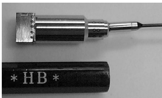
図4 鉛筆サイズの分光偏光計測センシングヘッド。
