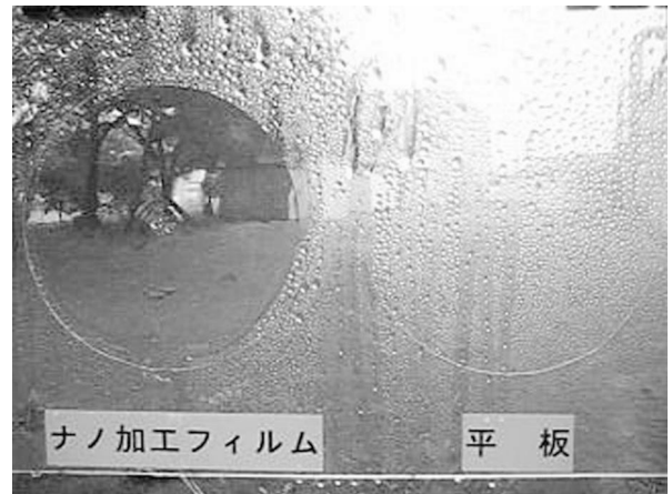
図4 大面積ナノ構造体による親水フィルム。
