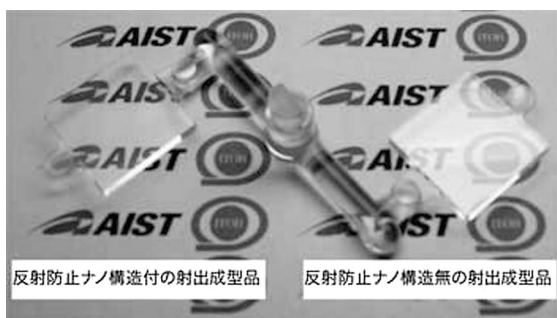
図8 反射防止ナノ構造付き金型を用いて射出成型した成型品。
