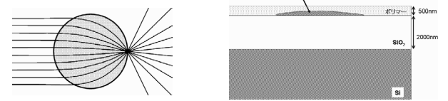
(左) Luneburg レンズ, (右) 作製したシリコン上の導波路構造の Luneburg レンズの断面
