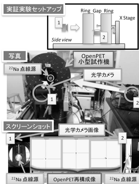
図3 リアルタイムイメージングシステムのコンセプト実証実験. OpenPET の開放空間で点線源を上下動させ, データ収集, 画像再構成, 表示までをリアルタイムに行った. フレームレートは毎秒2フレームで, 同時に撮影した光学カメラの映像に追随していることを確認した.
