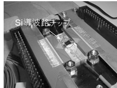
図6 シリコンフォトニクス技術を用いた光マトリクススイッチ。
